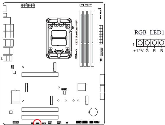
将 RGB LED 灯条连接到主板上的
