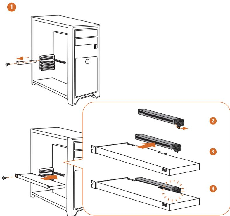
如果将显卡安装至 PCIE1 插槽，请跳过第 2 步。此处所示插图仅作为参考示例。
