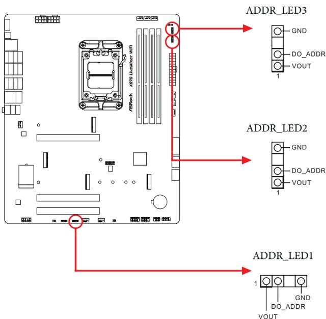
将可寻址 RGB LED 灯条连接到主板上的可寻址 LED 接脚 (ADDR\_LED1 / ADDR\_LED2 / ADDR\_LED3)。
